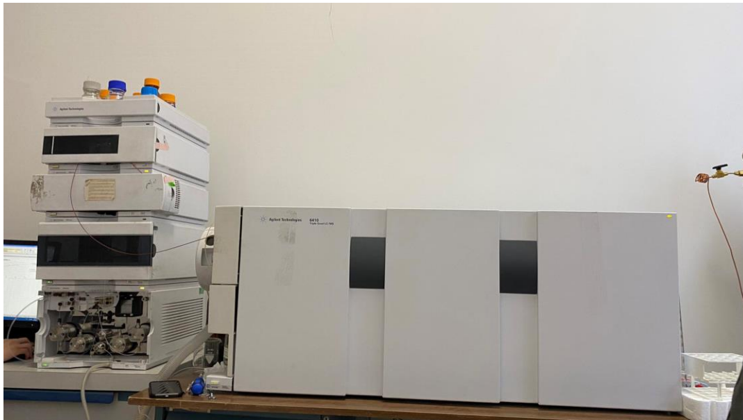
სურ 1. მაღალეფექტური სითხური ქრომატოგრაფი & მას სპექტრომეტრი. Agilent Technologies 1290 Infinity & Agilent Technologies 6410 Triple Quad LC/MS.
